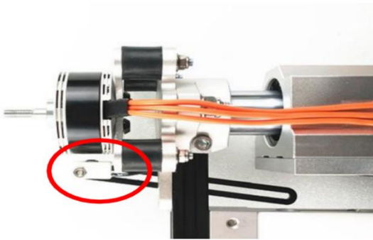
图2.3.1 温度传感器安装位置
